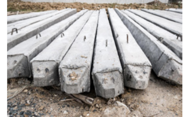
Referentie Betonnen palen (Khрутmuang, n.d.)
