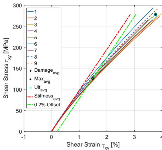
(d) ET test shear stress vs shear strain - triax back facing.
