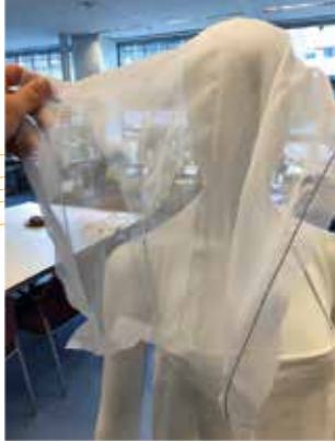
First result of fiber optic cable integrated chivon
