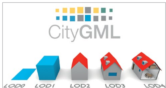
Figura 2. Schematizzazione grafica dei 5 LOD di base dello standard CityGML (cfr. nota 11 p. 129).
