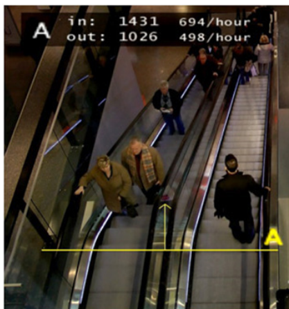
Figuur 5.3, 5.4: Voorbeelden van de wijze waarop een camera via software het aantal passanten telt (links) en het aantal gebruikers in een veld (rechts)
