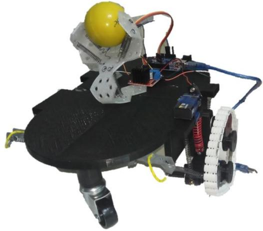
FIGURE 13: FINAL PROTOTYPE OF THE AT-GT WITH IMPLEMENTED GRASPER
