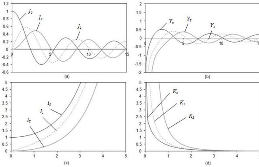
Figure E.1: (a) First Kind Bessel Function ; (b) Second Kind Bessel Function ; (c) First Kind Modified Bessel Function ; (d) Second Kind Modified Bessel Function
