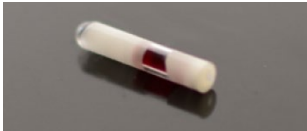
Fig. 25 — Shockwatch tube mini impact indicator (Sercalia, 2020-b)
