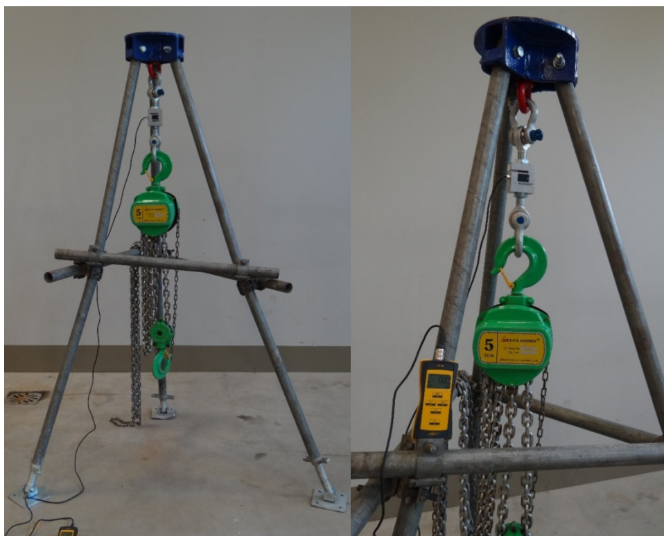
Abbildung 23: Versuchseinrichtung für Ausreißversuche (Fotos: Flegelskamp 2016).
