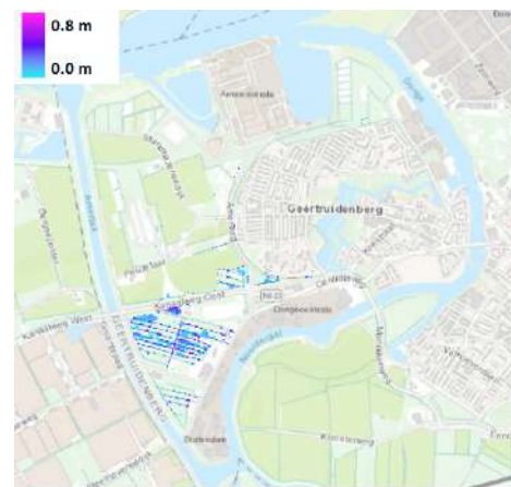
Figuur H.22: Inundatie door neerslag met herhalingstijd 10 jaar en 12 uur uitval van gemaal Middelschans
