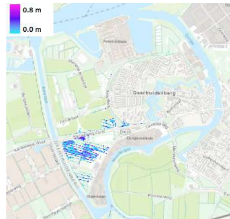
Figuur H.26: Inundatie door neerslag met herhalingsjijd 10 jaar en 20 uur uitval van gemaal Middelschans
