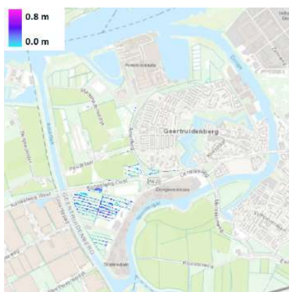
Figuur 5.17: Inundatie door neerslag met gemiddelde herhalingsstijd 10 jaar en 2 uur uitval van gemaal Middelschans
