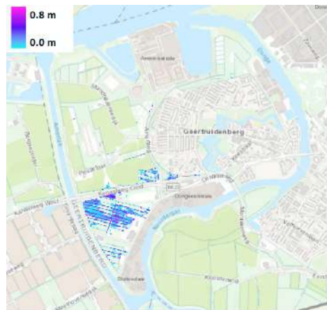
Figuur H.10: Inundatie door neerslag met herhalingsjtid 10 jaar en 24 uur uitval van gemaal Middelschans
