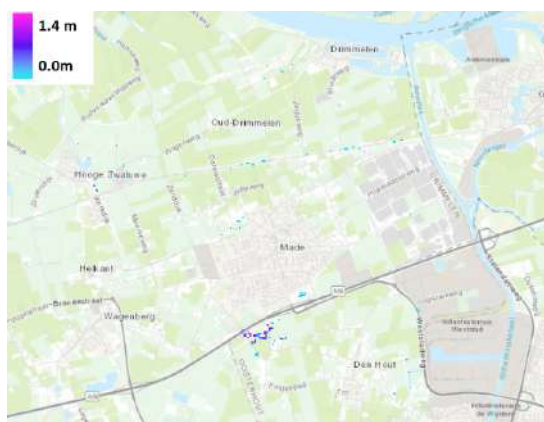
Figuur 5.25: Inundatie door neerslag met gemiddelde herhalingstijd 2 jaar en 24 uur uitval van gemaal Plukmade
