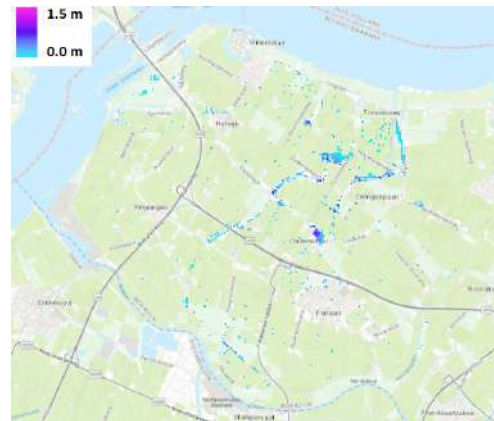
Figuur H.82: Inundatie door neerslag met herhalingsjijd 10 jaar en 4 uur uitval van gemaal Tonnekreek
