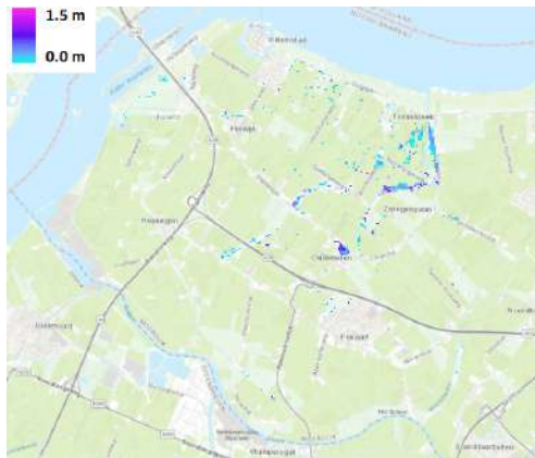
Figuur H.71: Inundatie door neerslag met herhalingsjijd 2 jaar en 24 uur uitval van gemaal Tonnekreek
