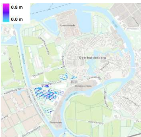
Figuur H.21: Inundatie door neerslag met herhalingstijd 10 jaar en 10 uur uitval van gemaal Middelschans
