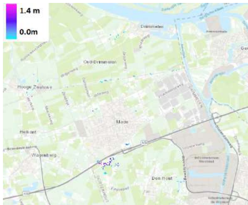
Figuur H.43: Inundatie door neerslag met herhalingsjijd 2 jaar en 48 uur uitval van gemaal Plukmade
