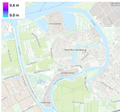
Figuur H.9: Inundatie door neerslag met herhalingsjtid 2 jaar en 24 uur uitval van gemaal Middelschans
