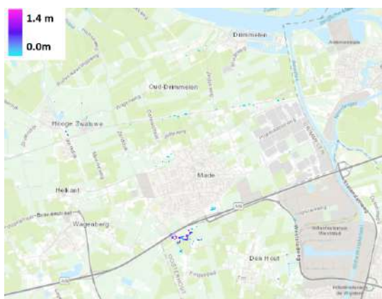
Figuur H.39: Inundatie door neerslag met herhalingstijd 2 jaar en 24 uur uitval van gemaal Plukmade
