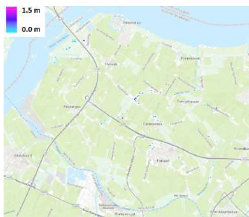
Figuur 5.33: Inundatie door neerslag met gemiddelde herhalingstijd 2 jaar gemaal Tonnekreek
