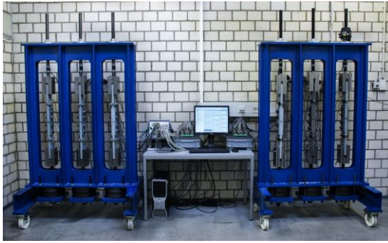
a) test rig for extended creep tests (UDE)
