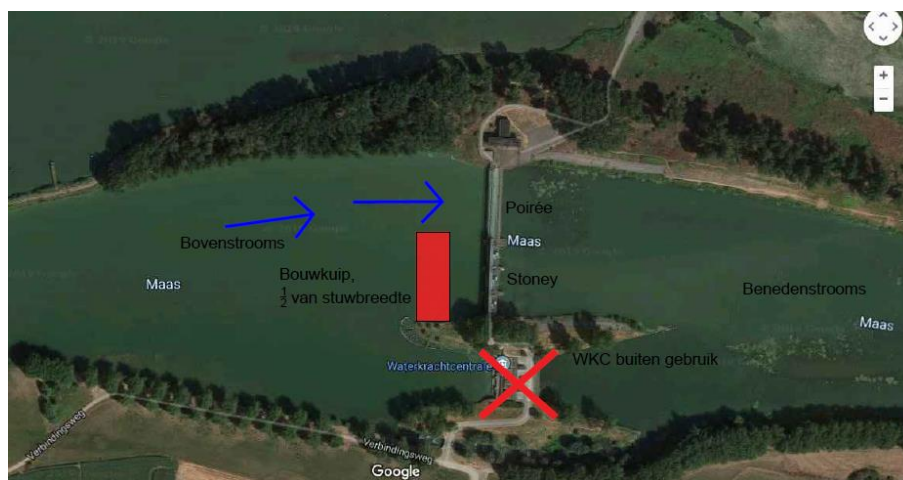
Figuur 65 - Fasering met twee bouwkuipen (auteur)
