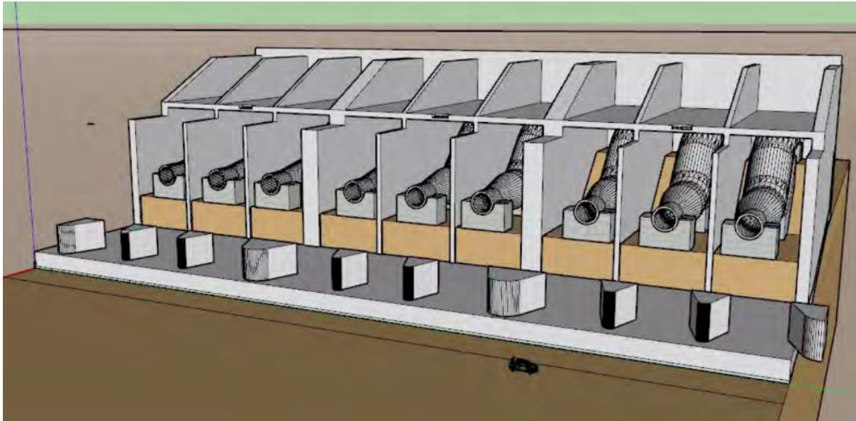
Afbeelding 13. Een van de caissons die fungeren als huis voor de pompturbines (Ansorena Ruiz, 2020)
