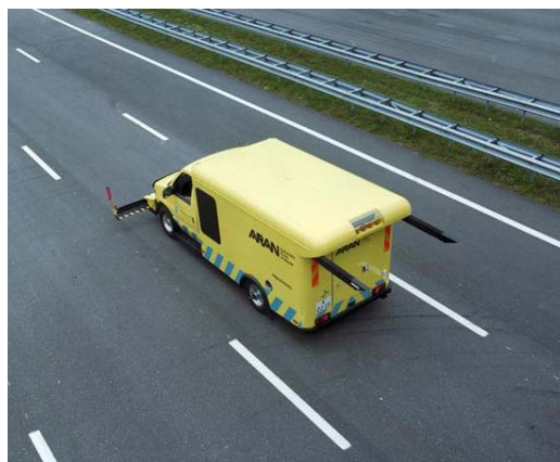
Figure B-2: The automatic road analyser [58]. Image courtesy Rijkswaterstaat. https://beeldbank.rws.nl/MediaObject/Details/139600
