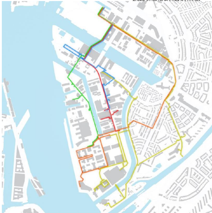
Figuur 3: Ondergrondse ligging van de vijf MS-kabels die in de zomer van 2021 stroom leverden aan BZOH; gebaseerd op informatie van Liander en afgeleid door gebruik te maken van PDOK.nl/viewer: Elektriciteitsnetten
