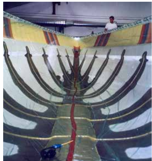
Afbeelding 4 Vacuüm-infusie van een 55-voet zeilbootromp (CLC TNO-TUD).
