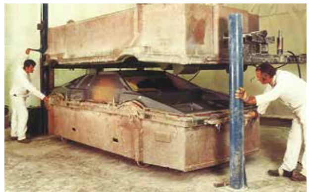
Dat revolutionaire proces dat vóór de Lotus Esprit werd toegepast heet 'vacuum assisted resin infusion', kortweg VARI. (Foto: Lotus)
