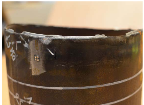
(d) Close-up of rupture surface (piece 2)
