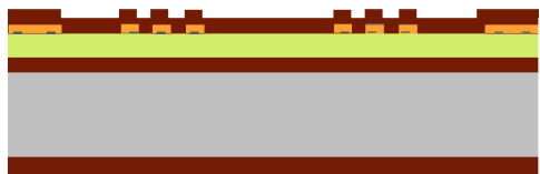
9. 500 nm PECVD SiN deposition.
