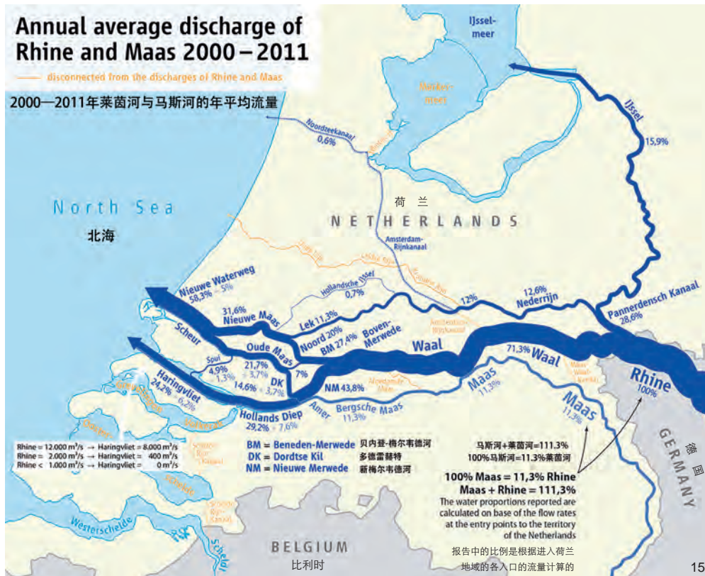
15 荷兰河流流量监管 (2000—2011 年) Regulation of the discharge of Dutch rivers 2000-2011
