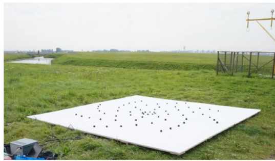
a) Acoustic array
