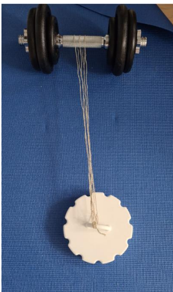
Figuur E15: Testopzet krachttest dop.
