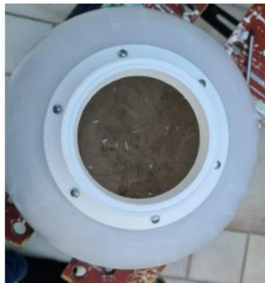
Figuur F10: Bol met alle vastgedraaide bouten.
