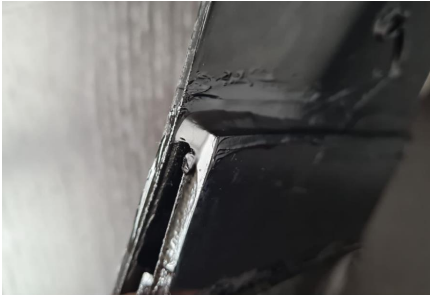
Figuur 5.2: Weergave van de elasticiteit van de kitrand aan de PE plaatjes.
