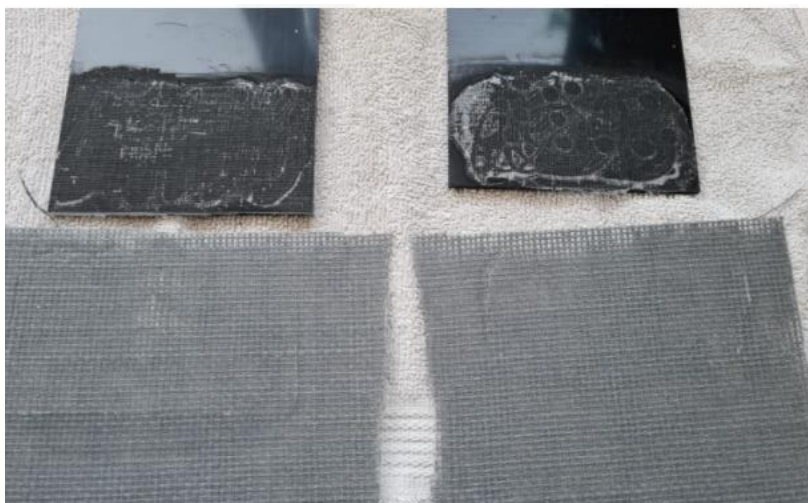
Figuur 5.1: Kunststof- en lijmresten van de PLA plaat aan de PE proefstukken.
