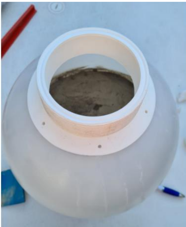
Figuur F7: Hals gelijmd op de bol met enkele druipsporen van de lijm.
