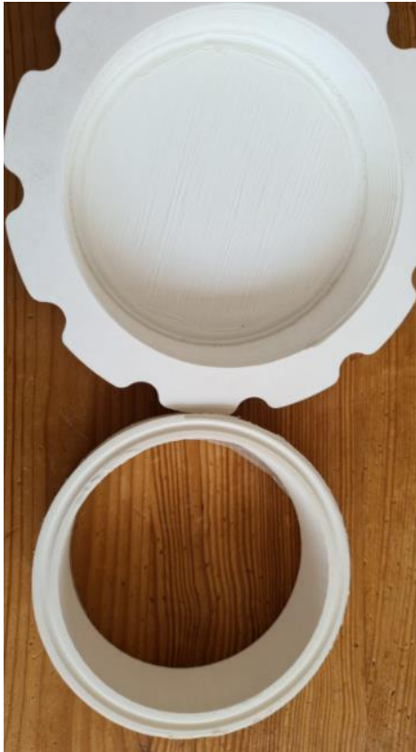
Figuur 4.2: Overzicht binnenkant van de PLA hals en dop.
