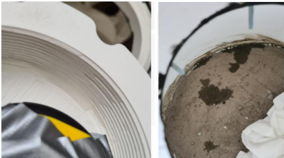
Figuur 7.2: Intreding van water in de dop (links) en de bol (rechts).
