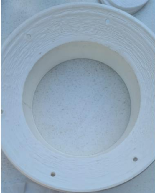
Figuur F4: Oneffenheden op de onderkant van de PLA halsrand.
