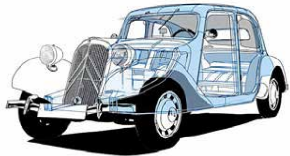
Afbeelding 2 Ook de Citroën Traction Avant had een zelfdragende carrosserie. (Illustratie: Koos Eissen)
