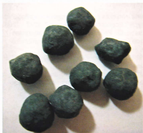
Afb. 5. IJzererts-pellets (ertsknikkers) uit Kiruna. De diameter van een pellet is ongeveer 1 cm. Wikimedia Commons/JJP.
