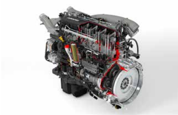
Afbeelding 1 Een MX-13-motor van DAF Trucks. Een 'doos' met gietwerk met lokaal een wanddikte van niet meer dan een paar millimeter (Foto: DAF Trucks N.V.)
