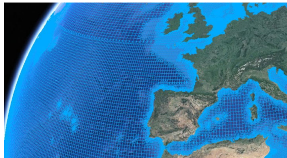
Figuur 2: Ongestructureerd grid zoals gebruikt in het wereldwijde stormvloedmodel GLOSSIS, gebaseerd op Delft3D-FM. Dichtbij de kust kan door het ongestructureerde grid de resolutie veel hoger worden gemaakt met onder andere driehoekige gridcellen.
