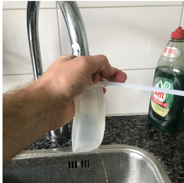
(d) Step 4: Pressurize the sleeve
