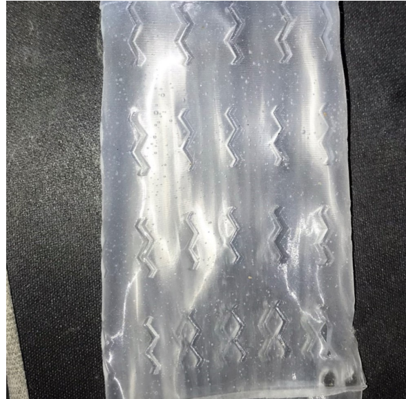
(d) Slits pattern debossed in the sleeve.
