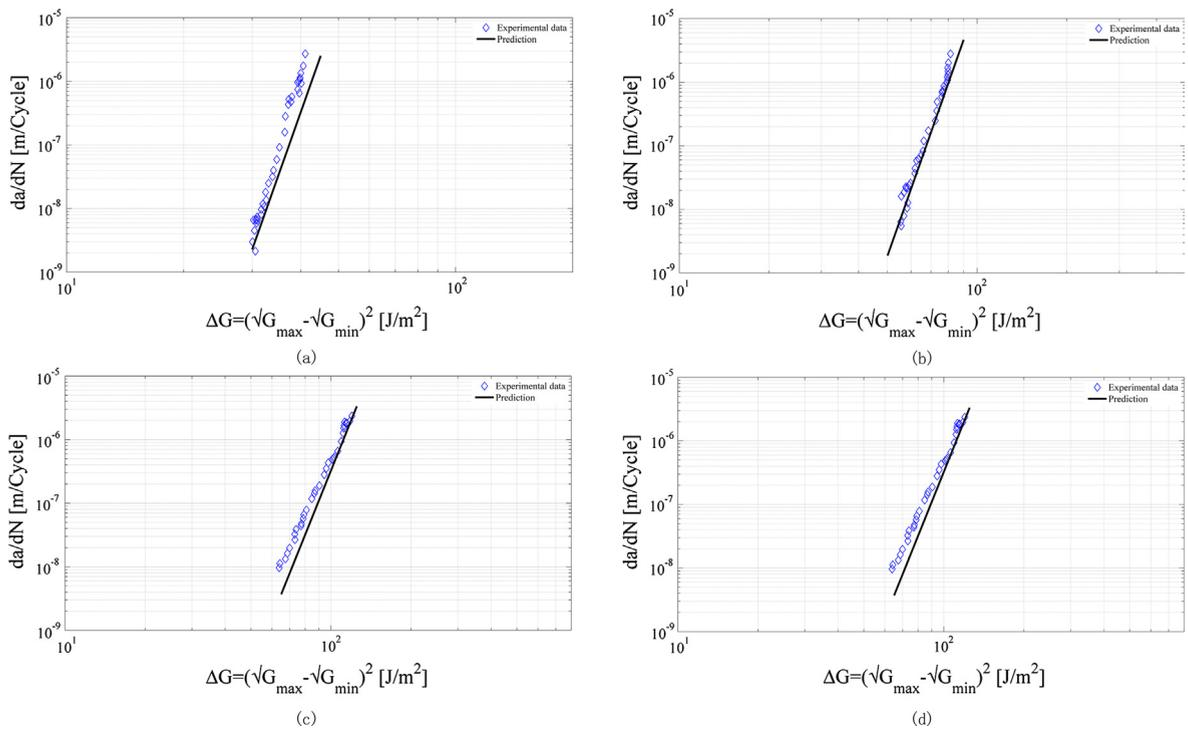
Fig. 10. Fatigue delamination predictions. (a)  $a-a_0 = 4.1$  mm; (b)  $a-a_0 = 11.8$  mm; (c)  $a-a_0 = 20.0$  mm; (d)  $a-a_0 = 28.4$  mm.
