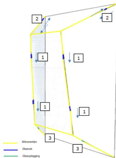
Figuur 7 - Overzicht type verbindingen tussen glaspanelen
