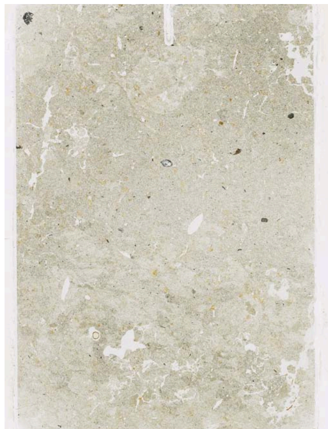
Fig. 37 Scan van monster 2. Met name onderin het monster is de vlekkerige aggregaatstructuur goed te herkennen. Mogelijk is deze ontstaan bij grondbewerking. Figuur D.J. Huisman.
