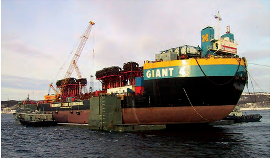
De Giant 4 met daaronder de Kursk en pontons in de haven van Moermansk.
