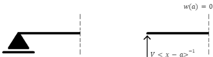
Figuur 9: Het modelleren van krachten voor een roloplegging met betrekking tot buiging.
