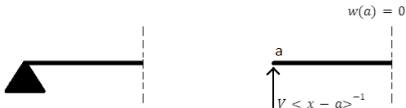
Figuur 8: Het modelleren van krachten voor een scharnieroplegging met betrekking tot buiging.
