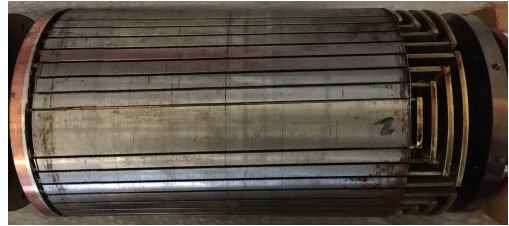
(d) Rotor 4 (big loop span, skewed)
