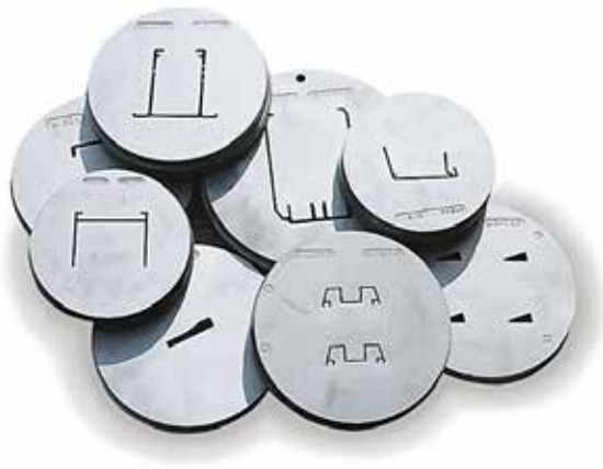
Afbeelding 1 Voorbeelden van matrijzen en extrusieprofielen. (Foto's: Hydro Extrusions Benelux | Elias Walpot Photographie)
