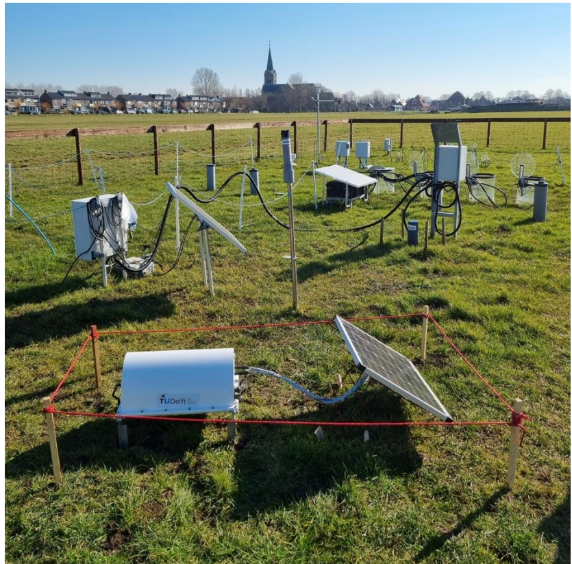
Figuur 18. Op de voorgrond een transponder meetopstelling in Assendelft.
