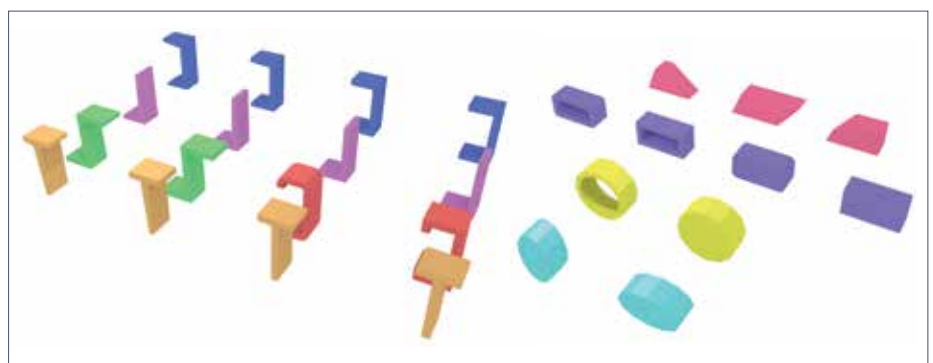
Figuur 1 - IFC kent veel parametrisch gecurveerde vormen zoals gebaseerd op de letters U, L, Z, C en T (links) en op trapeziums, (afgeronde) rechthoeken, cirkels met en zonder gaten en ellipsen (rechts).
