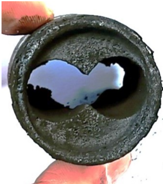
(d) Double hole geometry after third test.
