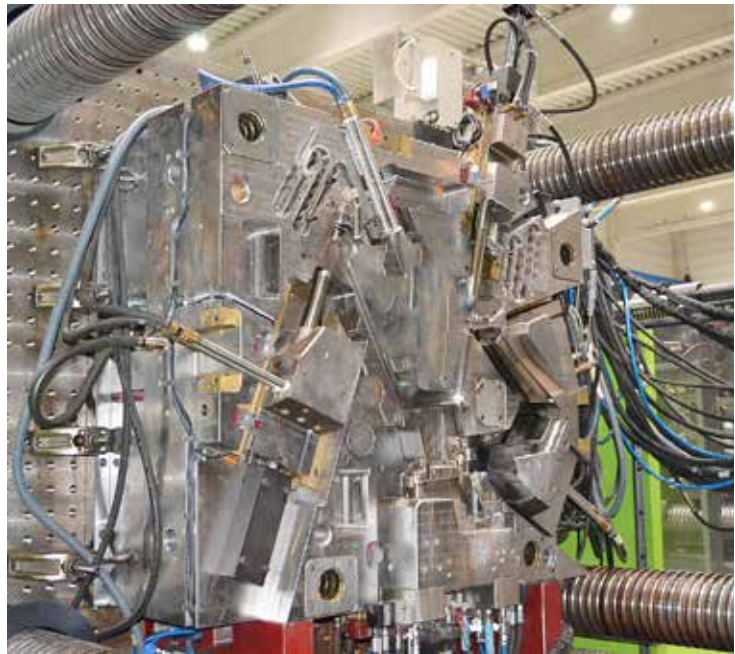
Afbeelding 6 De matrijs van de V Frames Velosione e-bikefiets - uitzonderlijke spuitgietkunde (V Frames / Michael Müller)
