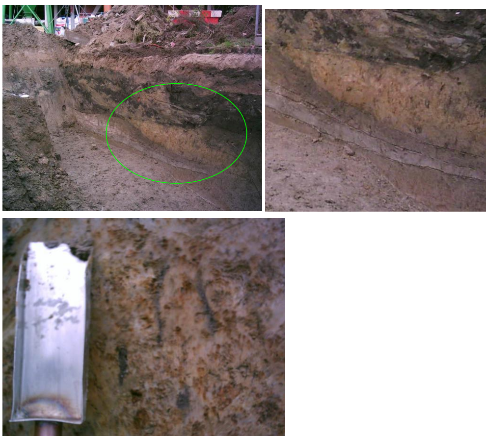
Figuur 7.3 Foto's kleilaag, ontgraving bouwplaats Masiusplein, Zevenaar.
