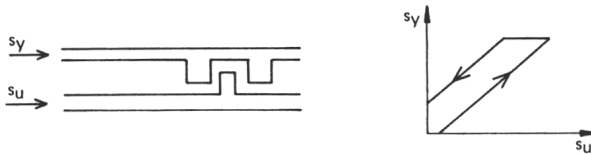
Figuur 2.20 Speling veroorzaakt een tweewaardige s_u - s_y -grafiek. In de grafiek zijn twee verplaatsingen tegen elkaar uitgezet. Het ingesloten oppervlak heeft niets te maken met een optredend energieverlies.
