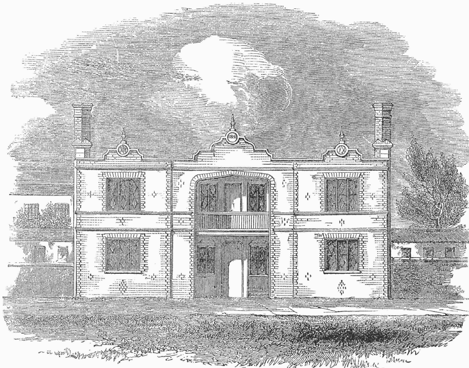
Figuur 11| Bouwtekening van modelwoning Voorzien van 1 arbeiderswoning aan iedere zijden en drie slaapkamers, respectievelijk voor jongens, meisjes en ouders apart. De plattegrond zou tot vier verdiepingen hoog gestapeld kunnen worden en naast elkaar kunnen worden geplaatst. De modelwoning kan zo goedkoper uitvesting bieden voor arbeidersgezinnen. (Roberts, 1851).
