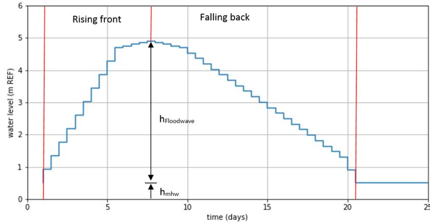
Figure 4.1: Flood wave parameters
