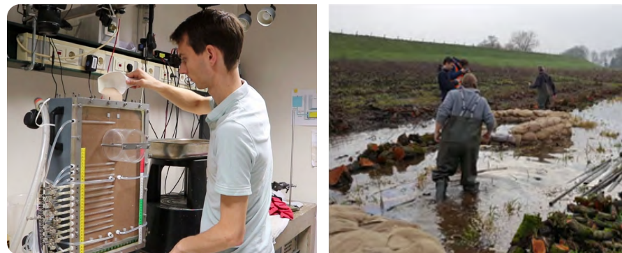
Figuur 2: Piping in het laboratorium. Foto's links door Toan Nguyen en foto rechts door Joost Pol.
