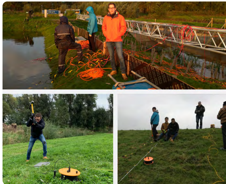
Figuur 2: Geofysisch onderzoek in dijken en bijbehorende instrumentatie. Foto's door Juan Chavez Olalla.
