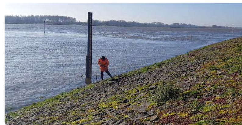
Figuur 1: Veldproef voor het bepalen van de nauwkeurigheid van visuele dijkinspecties bij Tiel. Foto door Wouter Jan Klerk.
