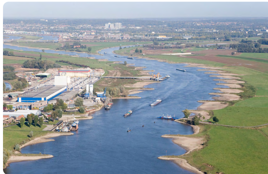
Figuur 2: Splitsingspunt van de Bovenrijn bij Pannerden, waar ongeveer 2/3 van de Rijnafvoer naar de Waal wordt gestuurd en de overige 1/3 naar de Nederrijn en IJssel wordt gestuurd. Foto door Rijkswaterstaat, beeldbank.rws.nl / Joop van Houdt.
