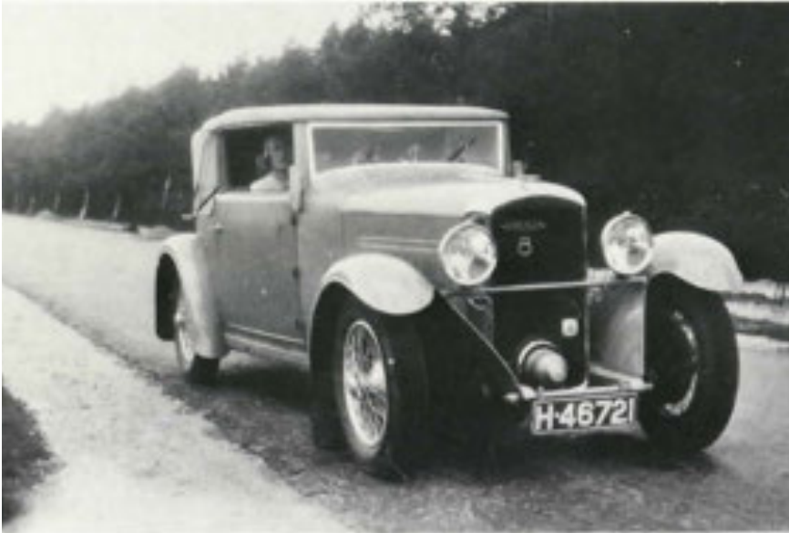
FIG. 5 De Amilcar 8 cilinder van Leen van der Vlugt, met mevrouw Van der Vlugt achter het stuur (bij de meeste Franse luxe-auto's was het stuurwiel rechts). De smalle hoge radiator hoorde bij het 'rijdend chassis' zoals dat werd geleverd door de Amilcar-fabriek. De strak gelijnde hoekige carrosserie, zonder treeplanken, was gebouwd op basis van aanwijzingen van de architect
