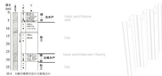
図-3 大粒自噴帯付近の主要地点のボーリング柱状図 (参考文献2)
