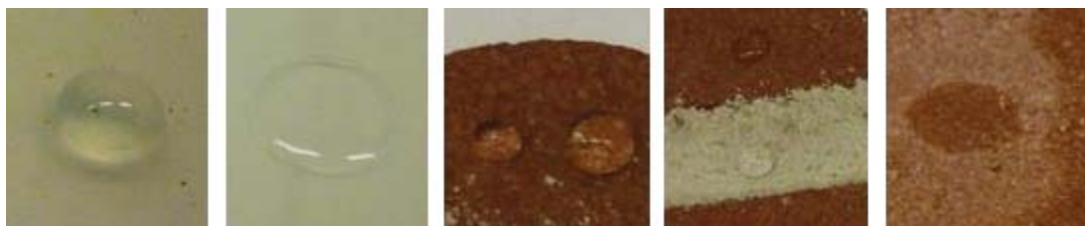
Fig. 3. (a) Druppel water op glas na behandeling met een bijenwas en (b) na het reinigen van de behandeling met heet water; (c) druppel water op baksteen na behandeling met bijenwas en (d) na het reinigen van de behandeling met heet water (e). Druppel water op een niet behandelde baksteen.
