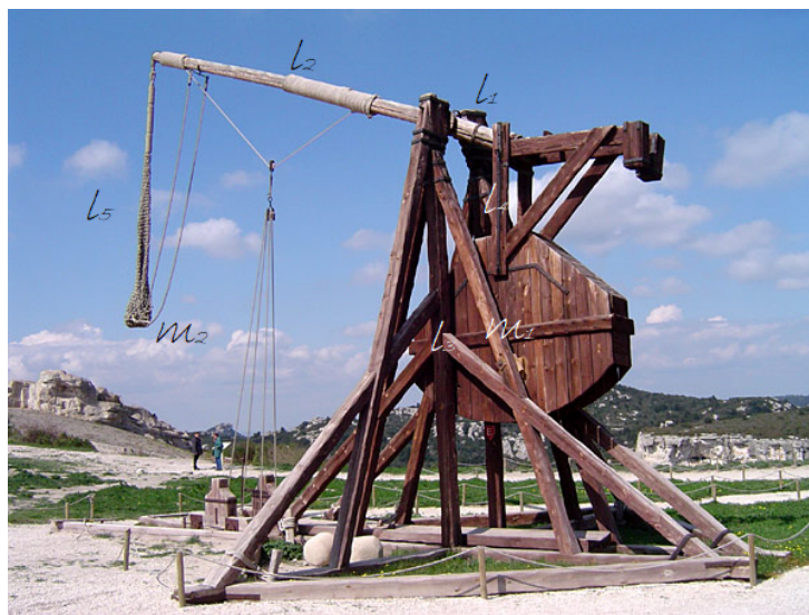
Figuur 1.1: Een nagebouwde trebuchet. Er is een verticale balk te zien ( l_3 ) met daarop een hoofdbalk ( l_1 + l_2 ). Links hangt het af te schieten voorwerp ( m_2 ) aan een touw met lengte l_5 . Rechts is het zware tegengewicht ( m_1 ) te zien die met een tussenbalk ( l_4 ) aan de hoofdbalk vast zit. [Onbekend]
