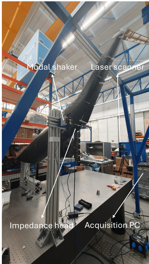
Fig. 4 GVT test setup
