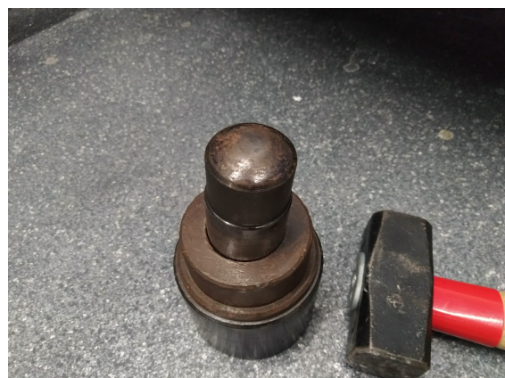
(d) Crushing the concrete.
